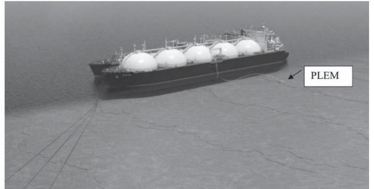
Εικόνα 3-10 Φωτορεαλιστική απεικόνιση αγκυροβολίου πλωτής μονάδας και PLEM
